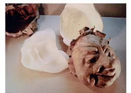
Danach erhält diese Form eine Schale aus Gips, um für das spätere Kaschieren eine stabile Grundlage zu bieten. Hierzu trägt man zunächst drei Schichten Gipsbinden auf dem Silikon auf und verteilt anschließend breiigen Gips darüber. Es empfiehlt sich, den Gips an der unteren Seite abzuflachen. So hat die Form beim Kaschieren einen festen Untergrund.
