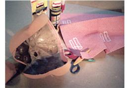
Nach vollständigem Aushärten werden im nächsten Arbeitsschritt die leicht erhabenen Kanten des angeklebten Tuches im Übergang zur Maske vorsichtig versäubert.
